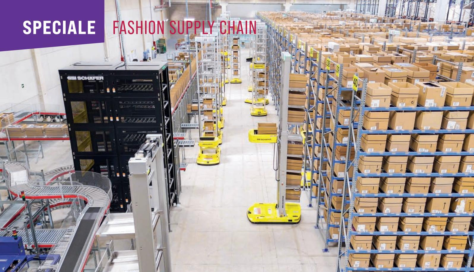
**SSI SCHÄFER ha progettato per Desigual una soluzione con i mobile robot RackBot, flessibile e facilmente scalabile, per poter sviluppare la dinamica necessaria in considerazione della situazione di spazio ridotto.**
