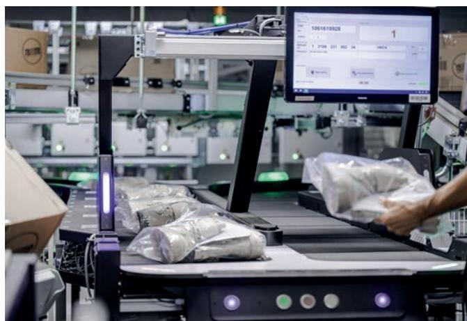
gresso vengono immagazzinati automaticamente e successivamente caricati nelle tasche AutoPocket da postazioni manuali e automatiche. Il sistema utilizza buffer intermedi e dinamici capaci di gestire fino a 32.000 articoli, assicurando un flusso continuo e ben organizzato verso le stazioni di smistamento e imballaggio. Qui, gli operatori possono confezionare fino a 850 articoli all'ora, in base al volume e al tipo di prodotto.
